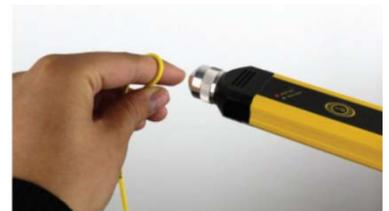
更可侦测这种讯号衰减。这种微小的弯曲，在实际应用上并不会引起正在传输讯号的光纤产生大量衰减，先将光源从光纤线材的一端输入，然后将光纤跳线稍微折弯，将 F3X 对准折弯处即可侦测此种微弱的光漏。
