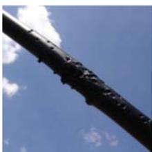
技术人员可藉由 Black Box F3XKIT1SCOPE 来侦测位于半空中的光纤线材，其可侦测光纤线材的表皮因火、鸟类、老鼠或小幅弯曲而形成的故障。当户外的某区域光纤线被怀疑有故障时，即可利用 F3X 来进行局部的扫描侦错。由于 F3XKIT1SCOPE 配有长距 1550nm 的光源侦测器以及瞄准用红点，当光纤线材的外被有破损时即可被 F3XKIT1SCOPE 侦测到，此类型的外被破损包括因火引起、
