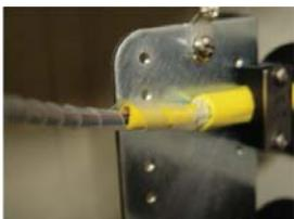
F3X 在讯号接收端点设计成 10~20 度的圆锥头，即表示越接近故障点，其准确率越高，相反地，当被扫描的表面超过 1 公尺直径外，从几公尺外侦测某些故障讯号是有可能的，因此当在进行故障排除时，最好是从远处再拉近距离，这个技巧可加速寻找故障点，并且可能对寻找单一收容箱内的多个故障点有帮助。因安装或生产上造成的弯曲、断裂皆会造成光漏并可藉由光源的强度来侦测光漏的程度、距离故障点的距离，深色外被的光纤线材比浅色的线材会造成光漏讯号的衰减约几个 dB，
